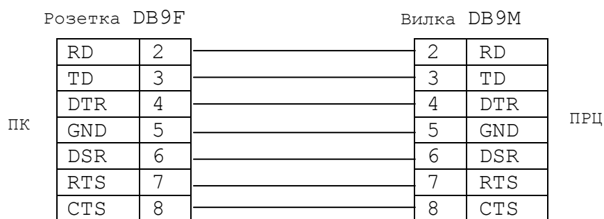
Рис. 6.1. Схема кабеля-соединителя для COM-порта
