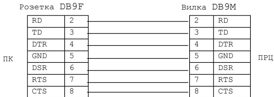
Рис. 6.1. Схема кабеля-соединителя для COM-порта
