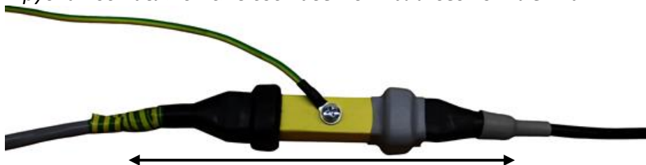
Рисунок 3. Установка защитных колпачков. Слева – фиксация изолентой, справа – осажена термотрубка. Длина в собранном состоянии 150-155 мм.
