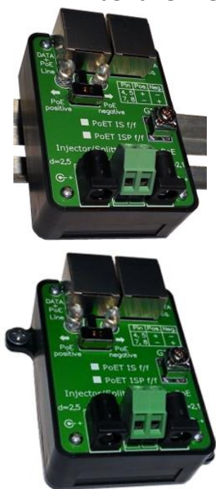
Рисунок 1. Сплиттер/инжектор Commeng PoET ISP f/f
