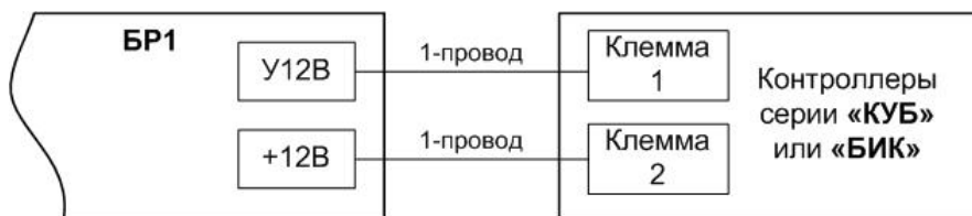
Рисунок 6 - Схема подключения изделия к контроллерам серии «КУБ»
