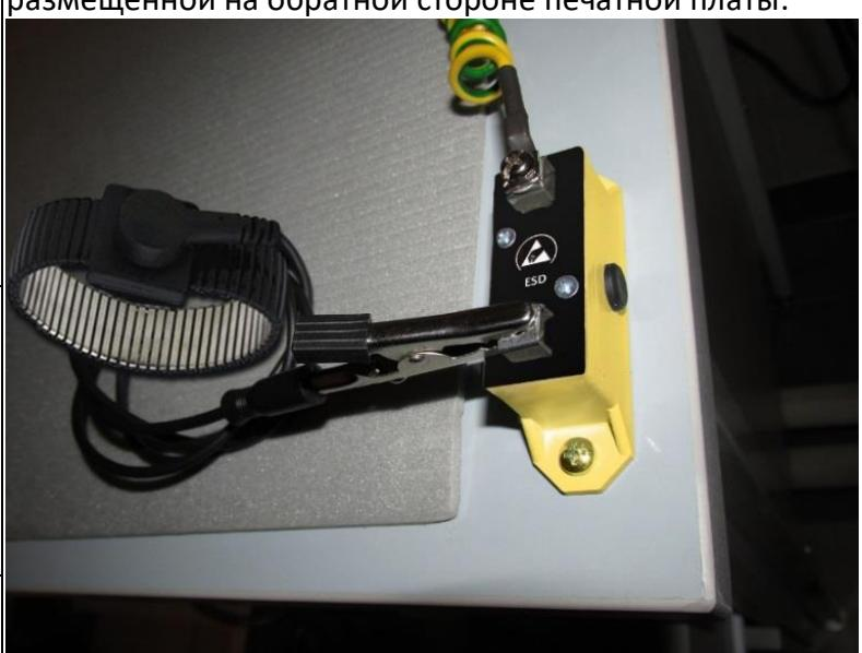
Антистатическая заземляющая панель выпускается по ТУ 27.33.13-014-38164566-2019, производитель ООО «Комменж». При заказе следует указать модификацию изделия. Пример заказа: **Антистатическая заземляющая панель АСЗП-КВ.**
