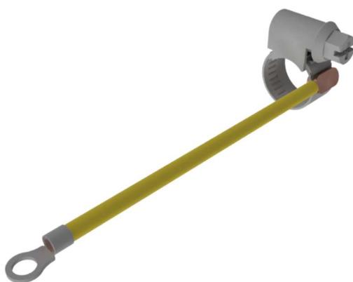
Контакт заземления оболочек, брони кабелей и труб **КЗ-ОБКТ** предназначен для заземления металлических покровов кабеля из различных материалов (стальные проволоки и ленты, алюминий, свинец), а также металлических труб. В ряде случаев может применяться для заземления экранов. Заземление выполняется на вводах кабелей и труб в шкафы, контейнеры, здания и сооружения.
